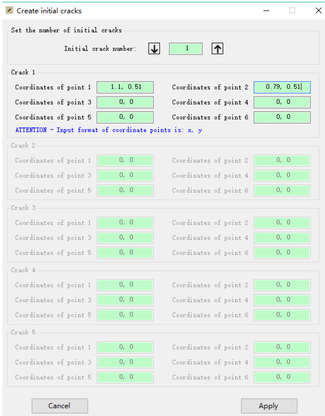
图 21 Create initial cracks 窗口设置
